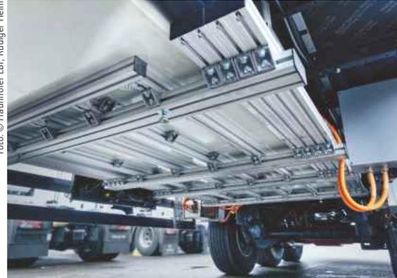
**Effizient und sicher:** Eine Forschergruppe entwickelt Hochvolt-Energiespeicher für elektrische Antriebs- und Energiesysteme von LKW-Trailern weiter.
