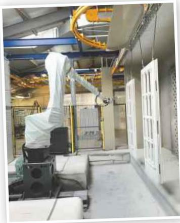
In der Produktion kommt u.a. ein Lackierroboter zum Einsatz.
